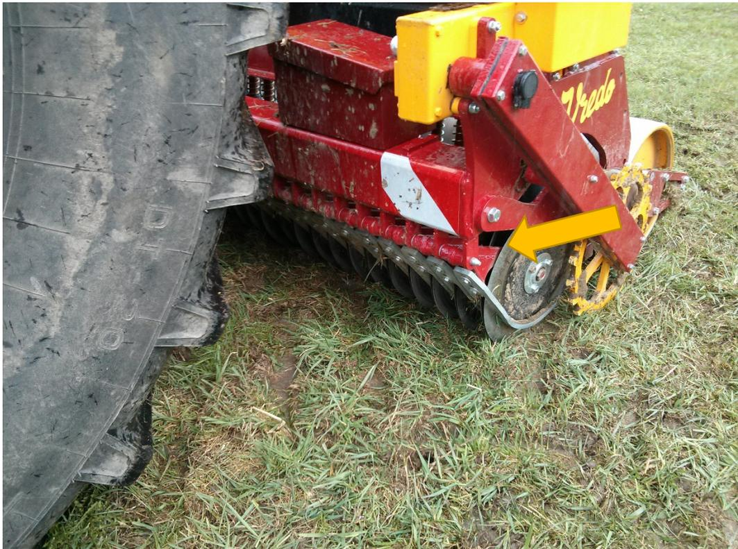
*Bild 58: Jeweils zwei konisch zueinander gestellte Schneidscheiben öffnen einen Säschlitz, in den die Pilzgerste abgelegt wird. Mit der wassergefüllten Walze wird der Schlitz möglichst wieder geschlossen; 16.4.2013.*
