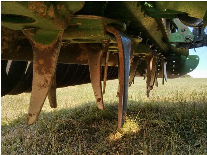
*Bild 34: Die auf Griff eingestellten Zinken des Amazone Kreiselschleppers zeigten eine sehr gute quetschende Wirkung auf den Engerling; 23.7.2013.*
