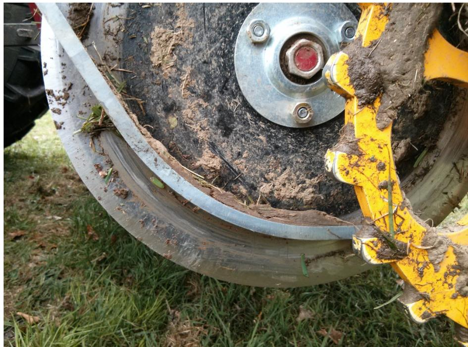
*Bild 57: Die Gleitkufen am Vredo-Schlitzgerät sind entsprechend nach oben zu biegen, damit die Schneidscheiben tief genug eindringen und die Pilzgerste mindestens 5 cm in den Boden ablegen können; 16.4.2013.*
