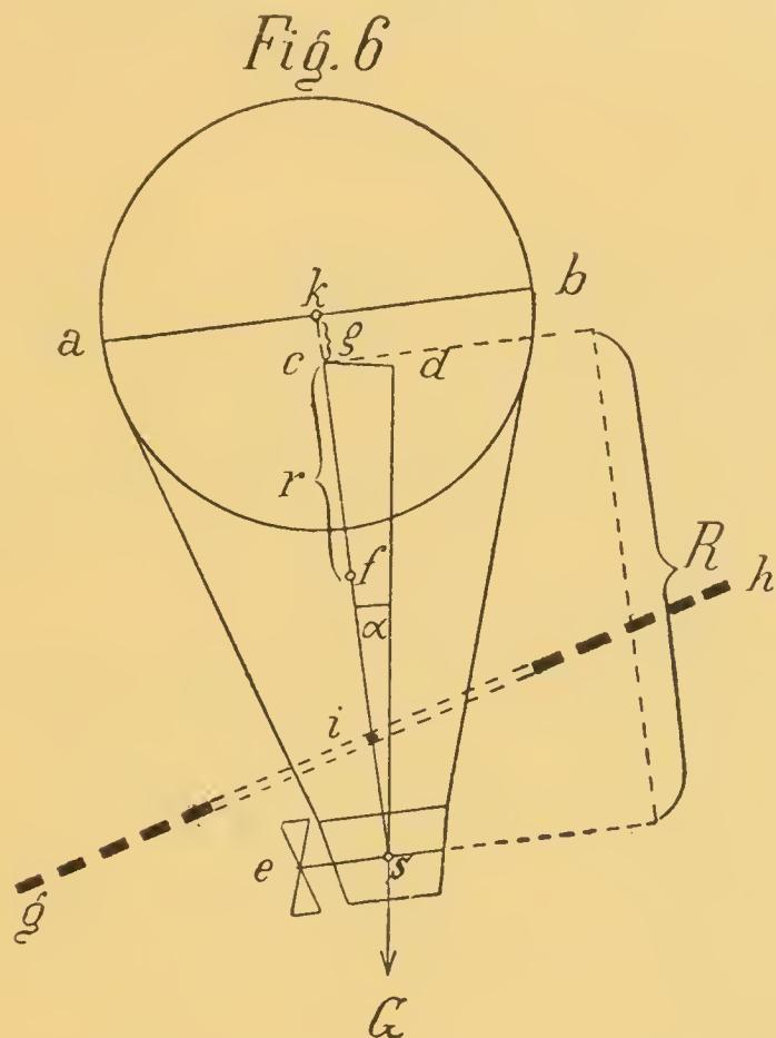
wie dies die Figur darstellt, durch den Schwerpunkt gehend, so ist die von  $d$  nach  $e$  übertragene Spannkraft  $= Q \cdot \sin \alpha$ . Befände sich aber die Flügelwelle oberhalb des Schwerpunktes  $s$ , also etwa in  $f$ , und bezeichnen wir  $cf = r$ , so wäre allgemeiner die von  $d$  nach  $f$  übertragene Kraft  $= \frac{R}{r} G \sin \alpha$ , und wenn  $v$  die Geschwindigkeit des Ballons bedeutet, die wegen Schieflage desselben verrichtete Arbeit  $=$
