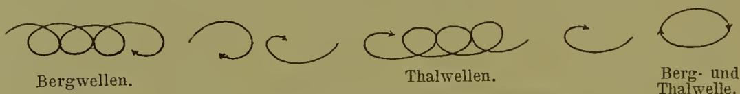
Fig. 20. Schwingungen der Flüssigkeitstheilchen.
