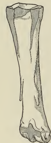
Fig. 20. L 431. ¼ nat. Gr. Starke Verwachsung schwacher Griffel- beine mit dem Meta- carpus. Die senk- recht schraffierten Flächen sind die für die Biegeversuche abgefrästen Auf- lagestellen.
