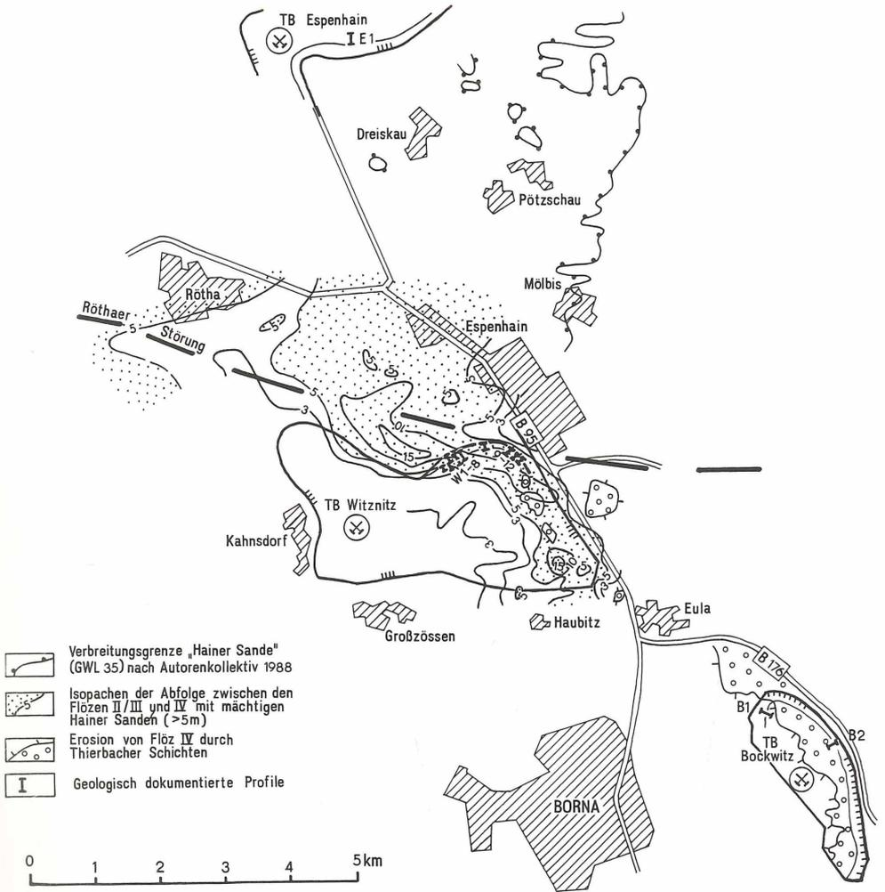
Abb. 3. Verbreitung der Hainer Sande im ehemaligen Tagebau Witzenitz nach Bohrungen und Stoßkartierung sowie Lage der geologisch dokumentierten Profile 1–12
