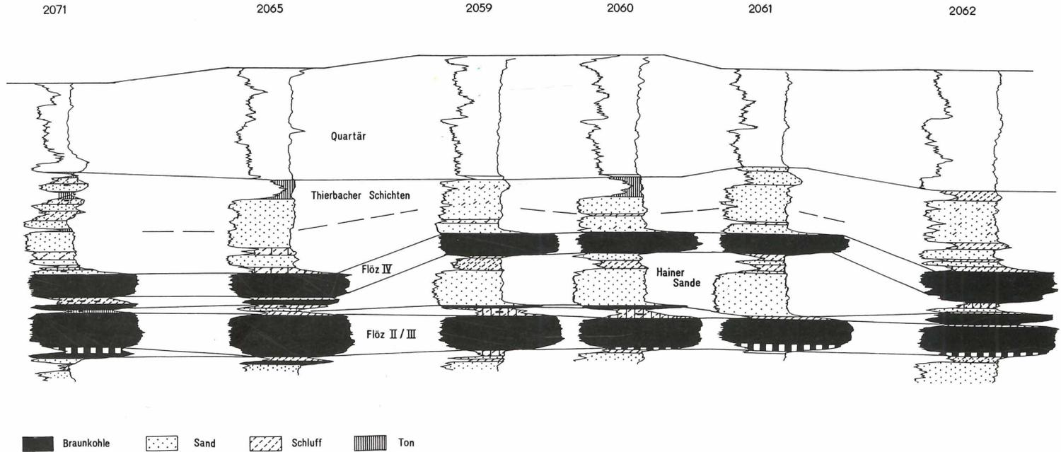
Abb. 2a. Bohrlochgeophysikalisches Korrelationsprofil (Bereich der dokumentierten Hainer Sande im Tagebau Witznitz) zur Verdeutlichung der lateralen Mächtigkeitsabnahme und der lithologischen Veränderungen (Bezugsniveau: Oberfläche des Flöz II/III-Komplexes, Länge unmaßstäblich)
