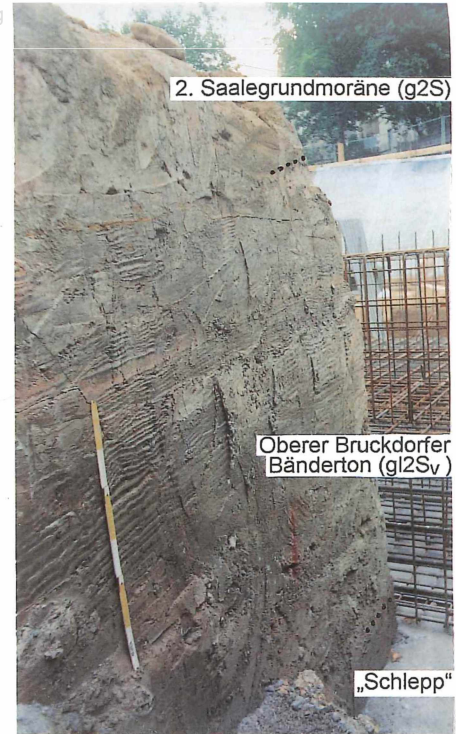
Bild 7. Auftreten des Oberen Bruckdorfer (Vorstoß-)Bändertons in Leipzig-Gohlis (temporärer Aufschluß Franz-Mehring-Straße 4–8). Innerhalb des Bändertons dieses temporären Aufschlusses waren eine Reihe setzungsbedingter Verwerfungen mit Abschiebebeträgen der Lagen bis zu 10 cm zu beobachten. Einzelne mächtige Schlufflagen („Sommerlagen“) waren ausgezeichnete Leitlagen für die Konnektierung des Stauseesedimentes. Foto JUNGE 1994.
