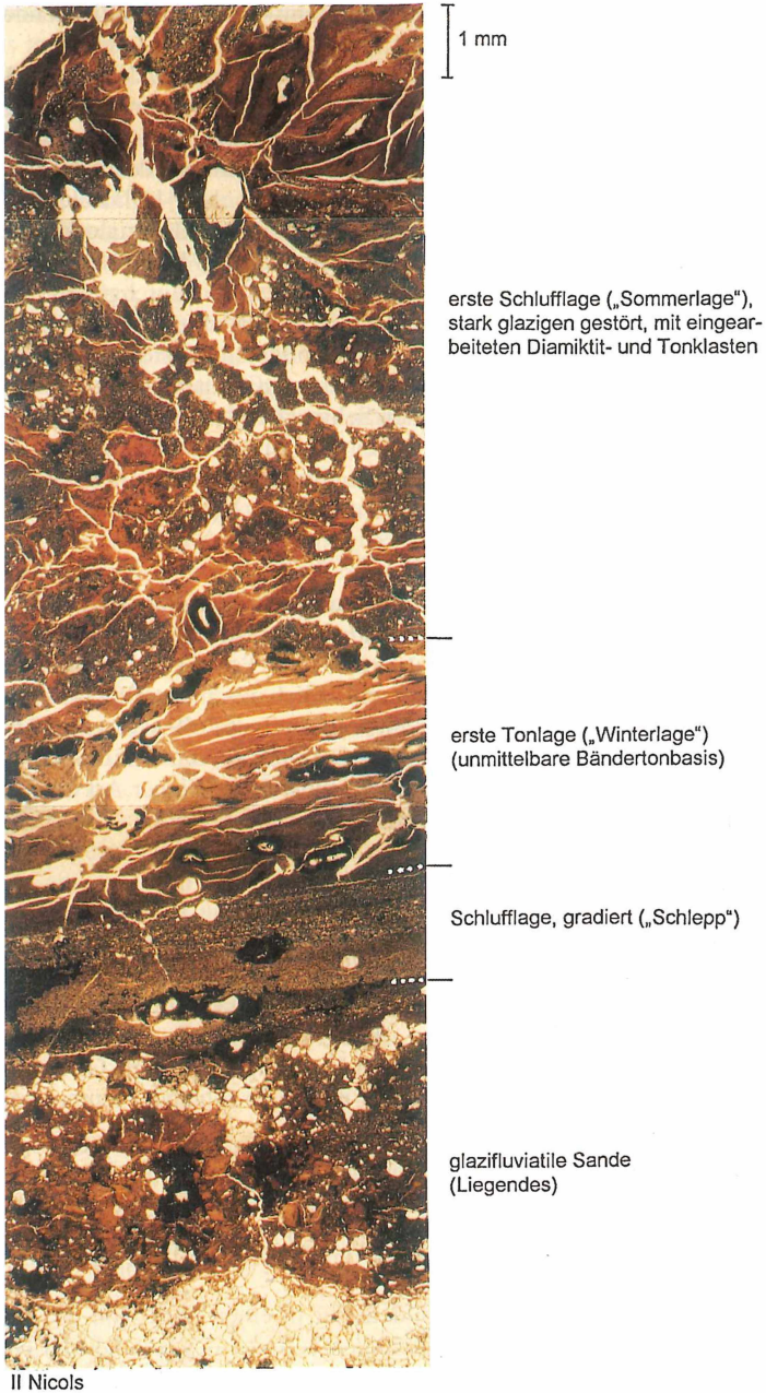
Bild 5. Dünnschliffbild des Oberen Bruckdorfer (Vorstoß-)Bänder-ton aus dem Tagebau Delitzsch-Südwest. Dargestellt ist der mikrotexurelle Aufbau des Liegend-Überganges des Stauseesedimentes: glazifluviale Sande – Stauseerandfazies („Schlepp“) – Bänder-ton im engeren Sinne.
