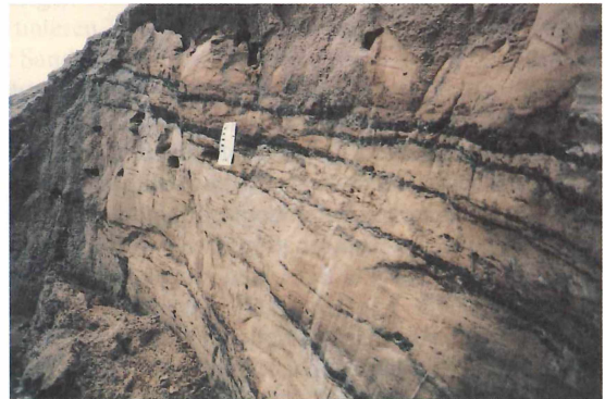
Foto 3. Bräunlichgrauer, vorwiegend horizontal geschichteter Fein- und Mittelsand mit schluffig-kohligen Lagen und Flasern und Braunkohlenbröckeln (Profil 1A, Schicht 1)
