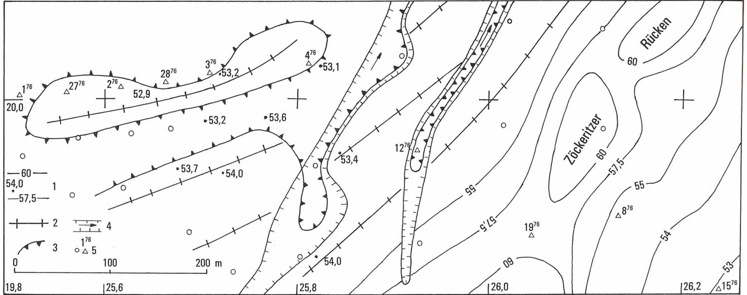
Abb. 2. Braunkohlentagebau Goitsche – Basisrelief des Bitterfelder Flözes auf der Nordwestflanke des Zöckeritzer Rückens (nach FUHRMANN 1977).
