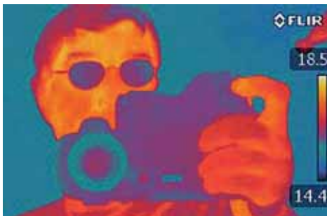
Abb. 4: Glas reflektiert Wärmestrahlung, so dass man nicht durch die Scheibe hindurch beobachten kann. Hier ein unbeabsichtigtes Selbstportrait des erstgenannten Autors mit Wärmebildkamera (FLIR T420) im Fensterglas.
