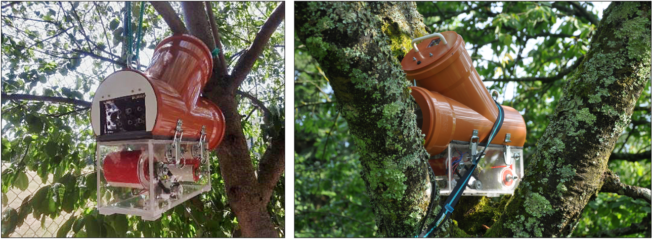
Abb. 10: Prototyp der GG-MU am Baum hängend und mit alternativer Befestigungsmöglichkeit durch Gurte. (Fotos T. Haalboom)
