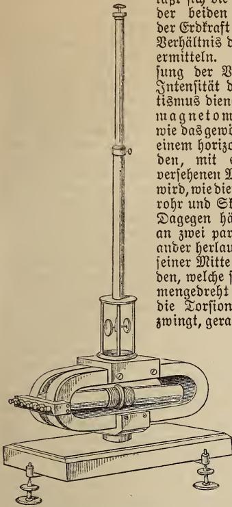
Fig. 2. Magnetometer (zugleich Spiegelgalvanometer).
