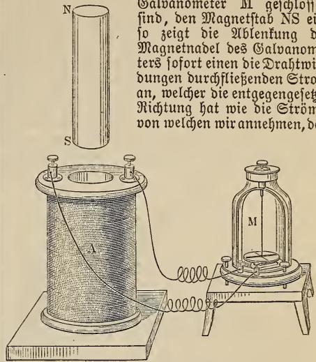
Fig. 2. Magnetinduktion.
