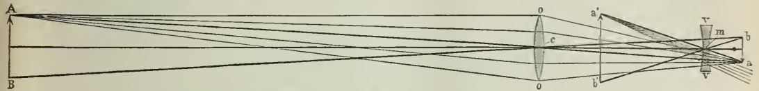
Fig. 2. Wirkung des Galileischen Fernrohrs.
