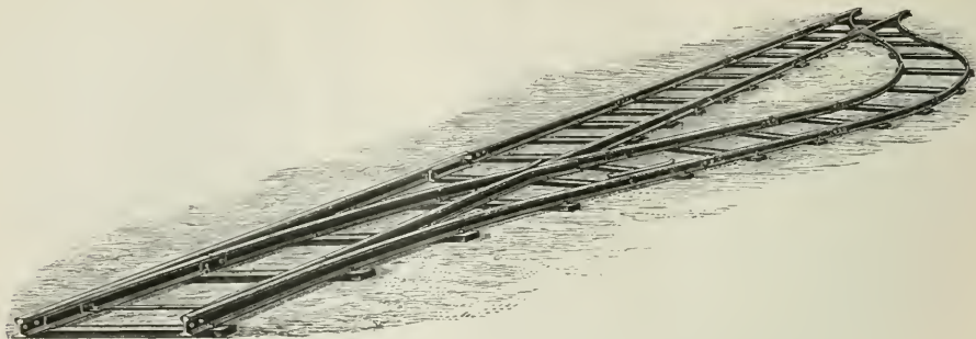
Fig. 6. Ausweichung mit Rechts- und Linkszungenweichen.
