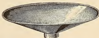
Fig. 1. Schüssel zum Verwaschen des Goldsand.
