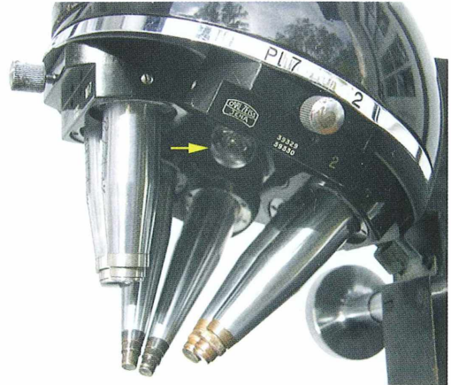
Abb. 3: Objektivrevolver mit vier Objektiven. Der Pfeil weist auf die zentral angebrachte Auflicht-Glühlampe.
