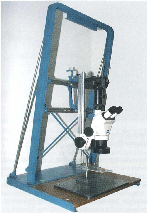
Abb. 7: Zeiss-Stemi Adaption an einem Vergrößerer unter Verwendung der senkrechten Säule.
