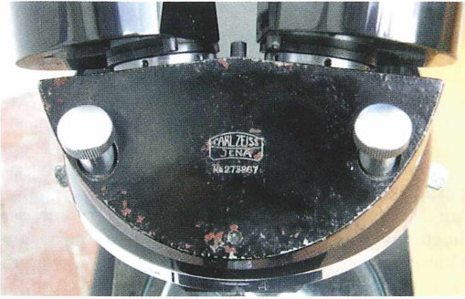
Abb. 2: Gravur auf dem Revolverhalter. Starke Korrosionsspuren sind offensichtlich.
