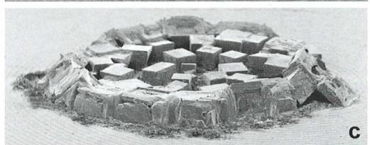
**Abb. 3a-c:** Unter verschiedenen Blickwinkeln dargestellte, aus jeweils einem kleinen ( $\varnothing$  ca. 3 mm) Tropfen einer Natriumchloridlösung resultierende Kristalle in rasterelektronenmikroskopischen Bildern (REM).
