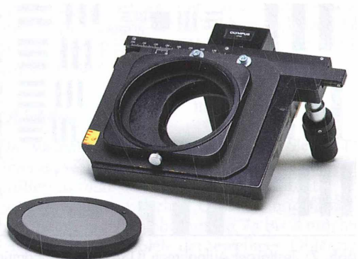
Abb. 9: Mikroskop-Tisch (Olympus BH) mit der Möglichkeit, unterschiedliche, drehbare Wechseleinsätze zu verwenden. Abgebildet ist der neutralgraue Einsatz.
