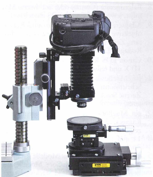
Abb. 1: Ausrüstung für mobile Lupenfotografie. Einfache manuelle Lösung, bei der die Einstellung über Grob-/Feintrieb eines umgebauten Zeiss Messmikroskops erfolgt.
