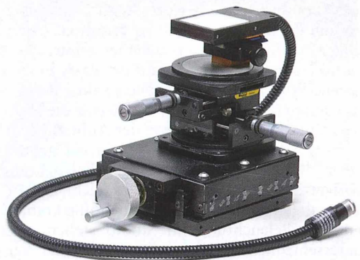
Abb. 11: Lineareinheit mit xy-Mikrojustiereinrichtung mit eingesetzter Flächenleuchte.
