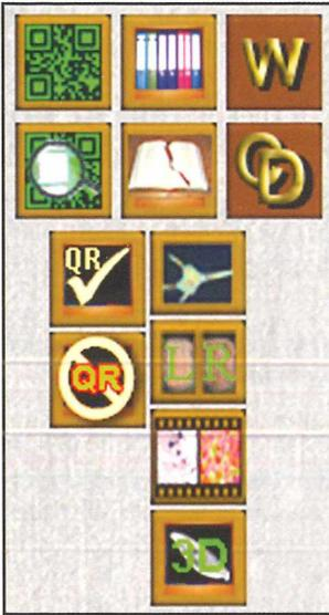
**Abb. 3:** Wird ein geeigneter QR-Code Scanner (Gryphon-GD44xx) angeschlossen, werden diese zusätzlichen Optionen zugeschaltet. Damit können Daten von Objektträgern eingelesen oder Datenbankabfragen mit einem einfachen Scan auf das Objektträgerlabel ausgelöst werden.
