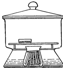
Abb. 3. Neutraler Vakuumexsikkator.
