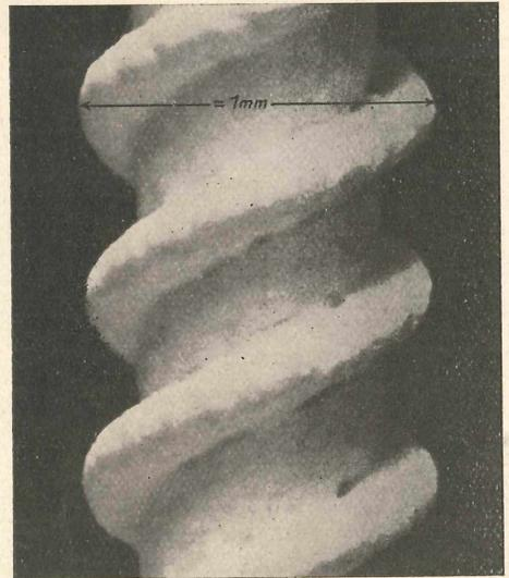
Abb. 5. Der fertige Heizer vor dem Einbau in die Kathodenhülse, 44f. vergr. (Werkaufnahmen Telefunken)
