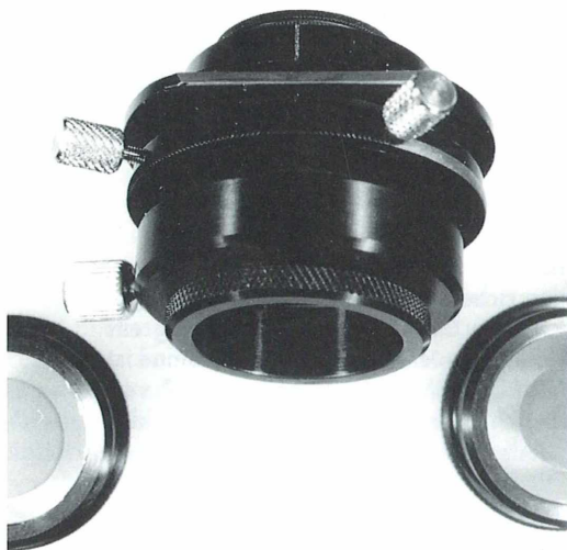
Abb. 1: Fluoreszenzcondensor 1,4 mit eingeschraubtem Halter, eingeschobener Zentralblende und zwei weiteren Zentralblendeinschüben.
