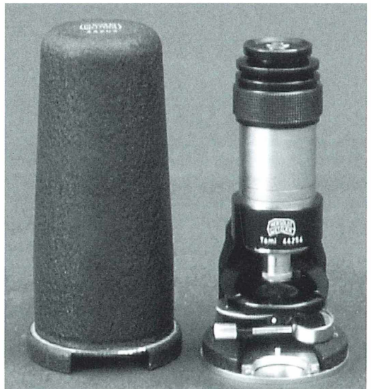
Abb. 2: Die ursprünglichste Version des Taschenmikroskops der Firma Hensoldt & Söhne, das Tami (Foto: G. Teichert, Berlin).
