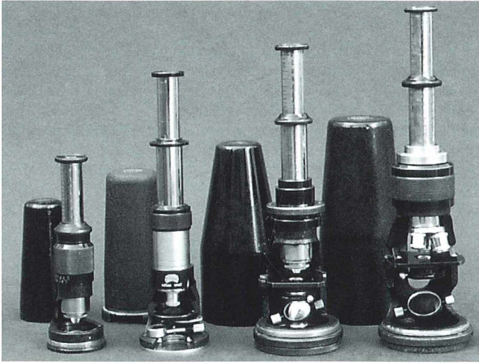
Abb. 3: Die Taschenmikroskop-Produktpalette der Firma Hensoldt & Söhne (von rechts nach links): zwei Versionen des Tami, das Metami sowie das Protami mit dazugehörigen Metall-schutzhülsen. Zu den Geräten wurde eine reichhaltige Auswahl von Zubehör und Nebengeräten angeboten wie zum Beispiel elektrische Beleuchtung, Dunkelfeldkondensor, Polarisationsapparat, Kreuz- und Drehtische, Insektentisch, Zeichen- und Projektionsapparate sowie Binokulartubus (Foto: G. Teichert, Berlin).
