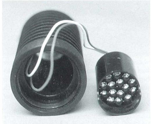
Abb. 7: Cluster mit gebündelten LEDs und Gehäuse.
