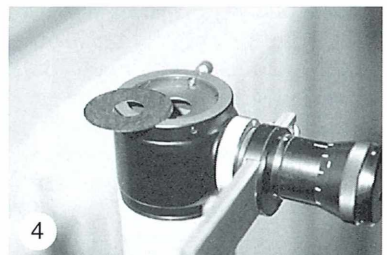
Abb. 2: Schlierenfilter. – Abb. 3: Blende unten am Tubus. – Abb. 4: Blende über dem Strahlteiler (Abbildungen 2–4: Ulrich Poggensee, Werder).
