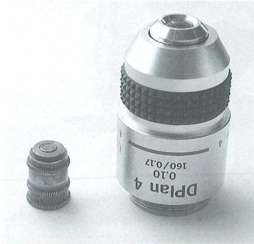
**Abb. 8:** Größenvergleich eines Bénèche-Objektivs mit einem relativ kurzen Objektiv moderner Ausführung.
