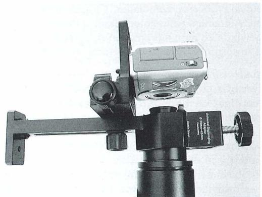
**Abb. 2: Montage einer Kompaktkamera (Casio Exilim EX-Z 110) mittels einfachem, externem Kameraadapter an einem Monokulartubus mit Fotookular.**
