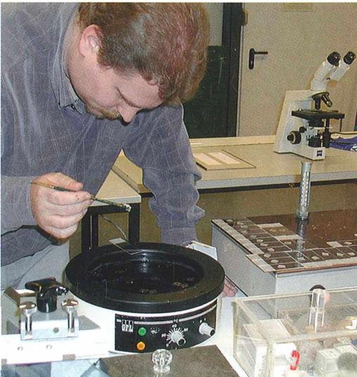
Abb. 1: Arbeit an Streckbad und Wärmeplatte.
