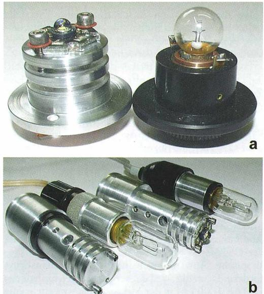
Abb. 1: Verschiedene Ausführungen der LED Soul. a Alter Lampensockel (rechts) im Vergleich zum LED-Sockel (links). b Kühlsockel, alter Lampensockel, Kühlsockel mit LED-Element, alter Lampensockel (von links nach rechts).
