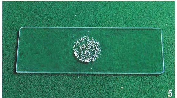
**Abb. 2:** Arretierungshilfe für Objektträger. – **Abb. 3:** Streumasken. – **Abb. 4:** Präparation, Aufstreuen des geschlämmten Materials. – **Abb. 5:** Auf dem Objektträger durch Schmelzfixierung arretierte Mikrofossilien.
