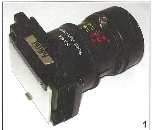
Abb. 1: Hama-Reprovorsatz zur Duplizierung von Kleinbild-Dias, Dia-Einschub mit Mattglas-scheibe (links), ausziehbarer Ringkombination mit 55 mm Schraubgewinde (rechts).
