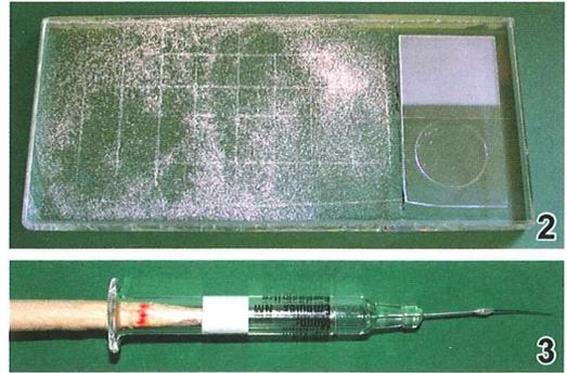
**Abb. 2:** Glasplatte mit aufgestreuten Radiolarien und Vorratsobjektträger. – **Abb. 3:** Legeborste, an Spritze montiert. Die Borste kann noch gekürzt werden.
