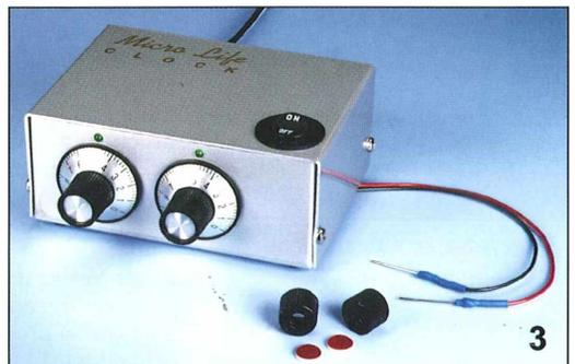
Abb. 3: Apparatur für die Durchführung von Galvanotaxis-Versuchen (nähere Details vom Verfasser erfragen).
