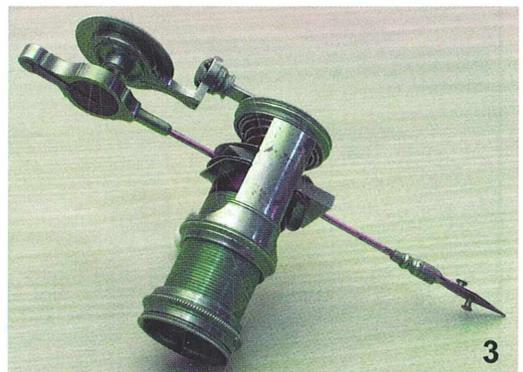
Abb. 2 und 3: Mikroskop für Auflichtuntersuchungen.
