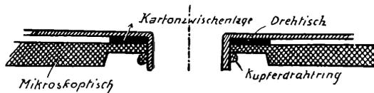
Abb. 2. Schnitt durch den selbstgefertigten Drehtisch. Um ein Wackeln des Drehtisches zu verhindern, ist auf den Rohranfang ein Kupferdrahting aufgeschoben.
