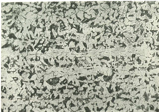
Abb. 3a. Stahl mit 0,31% Kohlenstoff, thermisch nicht behandelt. Die Grundmasse besteht aus Ferrit (hell), in welchem zeilenförmig angeordneter Perlit (dunkel) eingelagert ist; im mittleren, hellen Ferrit-Streifen ist noch eine fadenförmige Einlagerung von Schlacke enthalten. Die mechanisch-technologischen Eigenschaften sind schlecht. (Abb.-Maßstab = 100:1)
