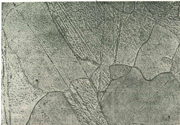
*Abb. 1. Reines Elektrolytisen („Ferrit“), bei welchem durch Korngrenzenätzung die Konturen der einzelnen Kristallite sichtbar gemacht sind. (Abbildungsmaßstab = 500:1)*
