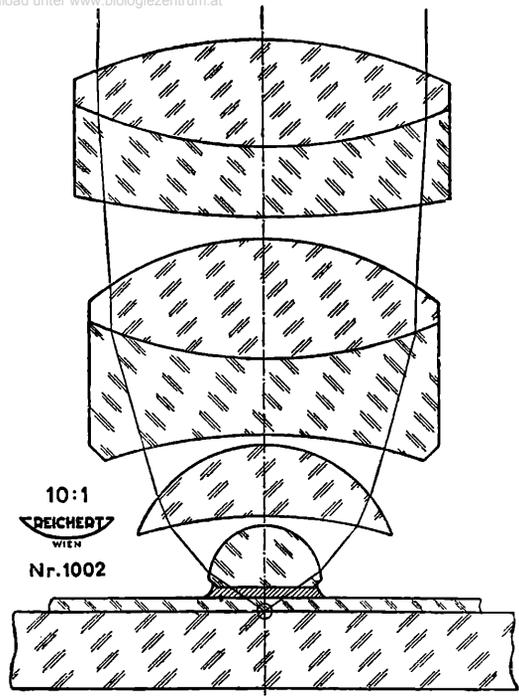
1. den Objektträger, 2. das Objekt (wegen seiner Kleinheit durch das Zentrum eines Kreises markiert), 3. das Deckglas, 4. die Immersionsflüssigkeit (Zedernholzöl), 5. die halbkugelförmige Frontlinse, 6. den positiven Meniskus, 7. die zweiteilige verkittete Mittellinse und 8. die zweiteilige verkittete Hinterlinse.
