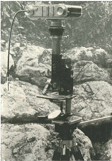
Abb. 2. Feldmikroskop „Heimdal“ von C. REICHERT, Wien, auf einem Photostativ befestigt, mit Kameraträger und Contax bei einer Freilandaufnahme.
