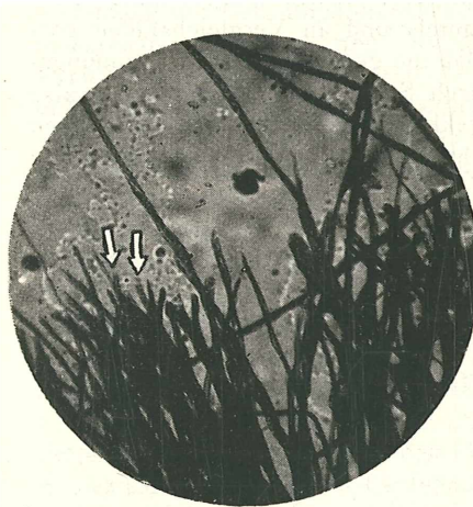
Abb. 11 und 12. Gespannter Faden, stumpfes Messer. Gegenüber Abb. 7 etwas gleichförmigere und geringere Gabelung und Zerfransung. In den Abb. 5, 7, 9, 11 befinden sich auch eine Anzahl gerissener Fasern dabei, was dadurch zustande kommt, daß durch die im „Faden“ — welcher ja seinerseits aus mehreren Einzel-fasern besteht — herrschende Spannung immer auch bereits einige solcher kleinster Fasern, sobald der Großteil der Fasern durchgeschnitten ist, reißen, bevor sie noch vom Schneidewerkzeug selbst erfaßt werden.
