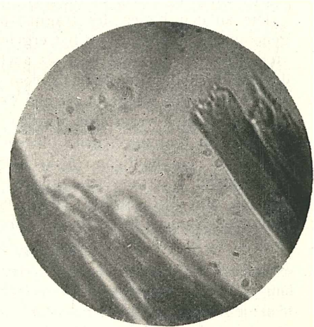
Abb. 11 und 12. Gespannter Faden, stumpfes Messer. Gegenüber Abb. 7 etwas gleichförmigere und geringere Gabelung und Zerfransung. In den Abb. 5, 7, 9, 11 befinden sich auch eine Anzahl gerissener Fasern dabei, was dadurch zustande kommt, daß durch die im „Faden“ — welcher ja seinerseits aus mehreren Einzel-fasern besteht — herrschende Spannung immer auch bereits einige solcher kleinster Fasern, sobald der Großteil der Fasern durchgeschnitten ist, reißen, bevor sie noch vom Schneidewerkzeug selbst erfaßt werden.
