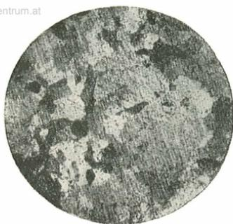
*Abb. 3 a. Antimonschmelze unbeschallt.      Abb. 3 b. Antimonschmelze beschallt.*
