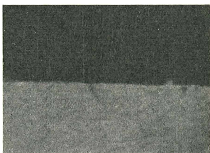
Abb. 13. Schnitt mit nicht eng aneinanderliegenden Scherenblättern.
