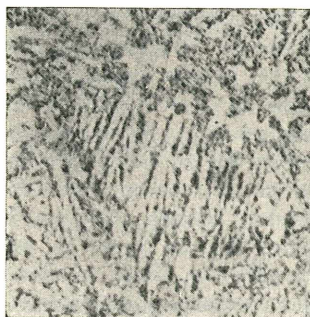
Abb. 9. Stahl „J“ (0,39% C, 0,40% Mn). Geätzt mit Xylol-Pikrinsäure. Abbildungsmaßstab 550:1.
