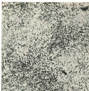
c Ofenabkühlung. Geätzt mit Alkohol- Pikrinsäure. + 20° C 9,4 mg/qcm
