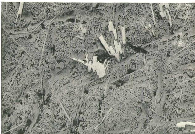
Abb. 11. Dieselbe Siemens-Martin-Schlacke wie in Abb. 5, jedoch mit  $\text{HF}$  geätzt, das allein den Wüstit färbte (im Bild die schwarzen Punkte). 100:1.
