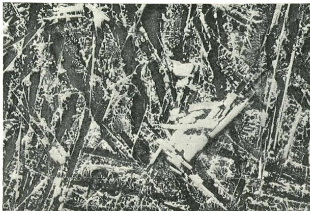
Abb. 10. ♂ Dieselbe Siemens-Martin-Schlacke wie in Abb. 5, jedoch mit alkoholischer  $\text{HNO}_3$  geätzt, wodurch sowohl das  $\text{C}_3\text{S}$  wie auch das  $\text{C}_2\text{S}$  Anfärbungen erhielten. 100:1.
