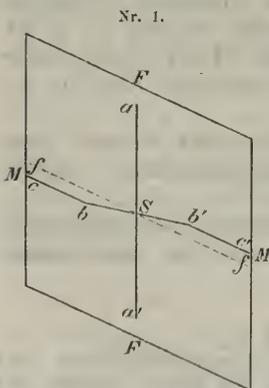
Die dem zweiten und dritten Blätterdurchgange entsprechenden Risse  $bc$  resp.  $b'c'$  und  $aa'$  zeigen sich mit blossem Auge und mit bis 140facher Vergrösserung — stärkere wurde nicht angewendet — als äusserst scharf und fein gerissene, continuirlich gerade Linien, also als Durchschnitte von Ebenen, das heisst als wirkliche Spaltflächen. Die der Richtung  $\frac{5}{9}P\infty$  entsprechenden Risse  $bb'$  sehen zwar mit blossem Auge und mit Hilfe der Lupe
