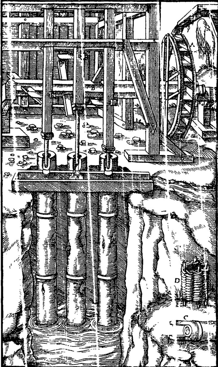
Abb. 18: AGRICOLA G. (1556). De re metallica. Erefridistorfische radpumpe.
