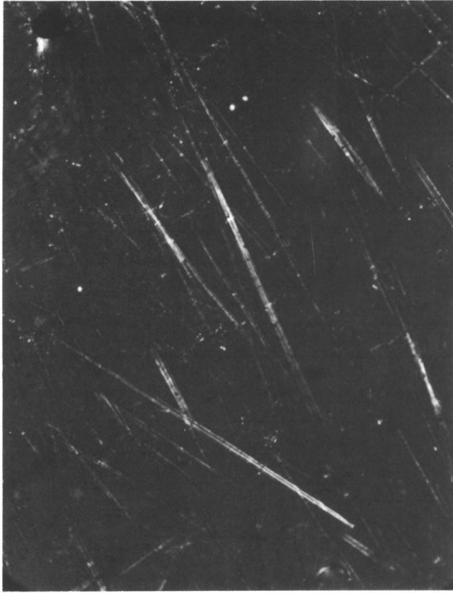
Abb. 6: Leistenförmiger Celsian ( \text{Ba}[\text{Al}_2\text{Si}_2\text{O}_8] ) in heller Erzschlacke. Stohren (Obermünstertal). Dünnschliff. Bildbreite 0,71 mm.
