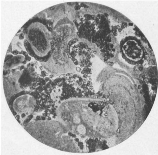
Abb. 3. gew. Licht, Vergr. 50 x Oolith mit körniger Grundmasse und Kalkspat
