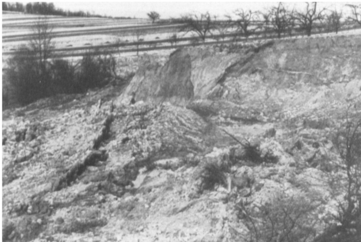
Abb. 12: Rutschmasse vom 2. und 3. 4. 1952 mit nordöstlicher Begrenzungsfläche des Rutsches in der Ziegeleigrube ZIPFEL in Lehen. Aufn. K. SAUER 1952.
