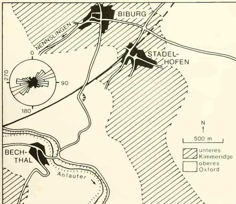
Abb. 3: Geologische Übersichtskarte der Umgebung des Steinbruchs von Biburg (abgedeckt). Die Kluftrose stellt die Kluftrichtungen im Steinbruch dar (234 Kluftmessungen).
