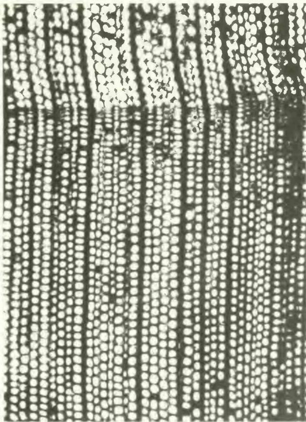
Abb. 1: Querschliff. Zuwachsgrenze, radiale Tracheidenreihen, dunkle Holzstrahlen, verstreute Parenchymzellen mit dunklem Inhalt. 1969 I 72;  $\times 40$ .
