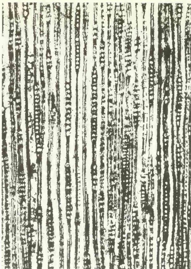
Abb. 2: Tangentialschliff. Einreihige, vielstöckige Holzstrahlen. 1969 I 72;  $\times 40$ .
