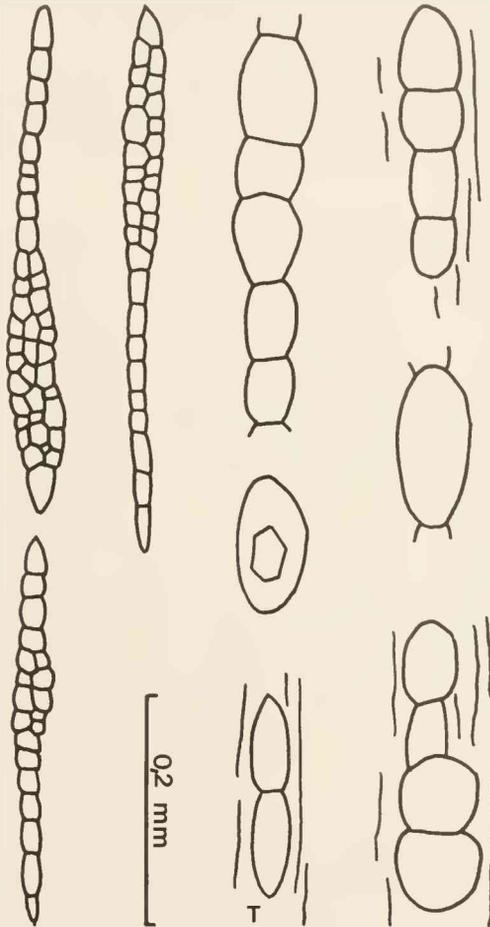
Abb. 8. Tangentialschliff (links). Häufige Form von Holzstrahlen und zwei Idioblasten (T). Radialschliff (rechts). Tonnenförmig vergrößerte Zellen, Idioblasten, vereinzelt mit je einem Kristall.
