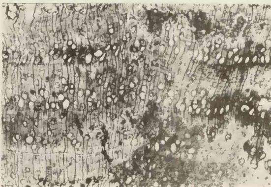
Abb. 1. Querschliff. Halbringporige Gefäßverteilung mit drei Zuwachszonen. 7×.
