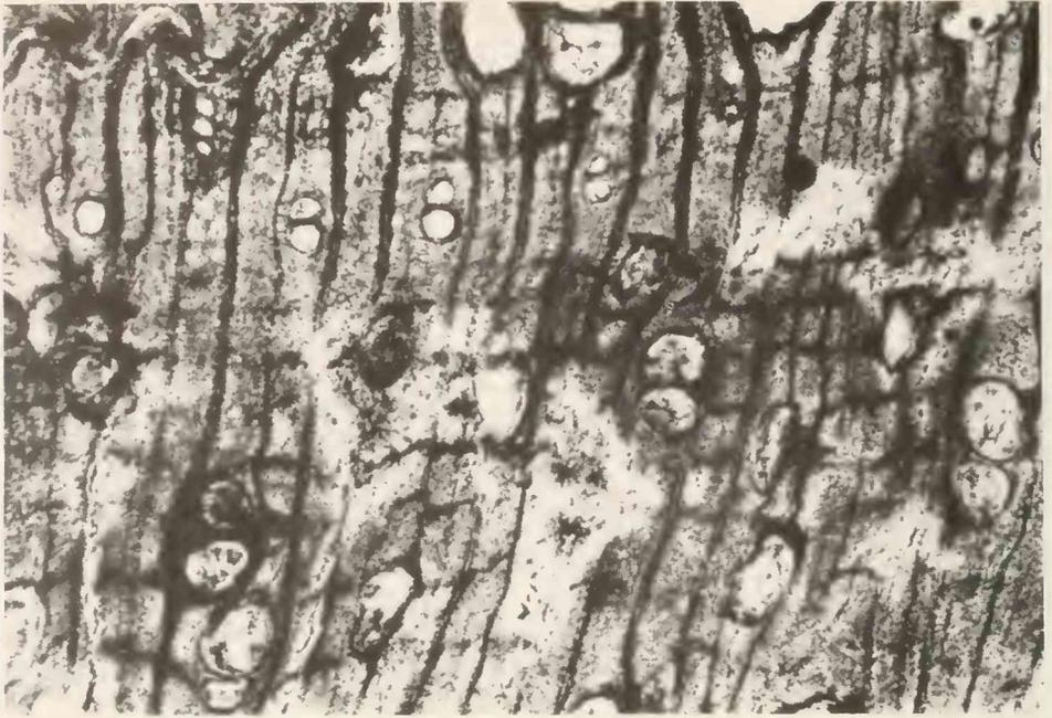
Abb. 2. Querschliff. Netzförmiges Muster zwischen apotrachealem Axialparenchym und Holzstrahlen (Mitte rechts). 55 $\times$ .
