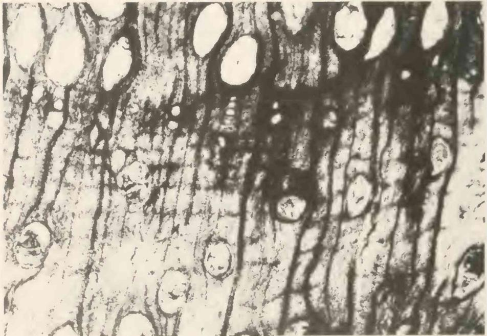
Abb. 3. Querschliff. Unterschiedliche Gefäßgröße zwischen kleinen Spät- und großen Frühholzporen. 55 $\times$ .
