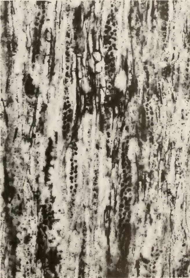
Abb. 6. Tangentialschliff. Ein- bis dreireihige Holzstrahlen und einige Idioblasten. 120 $\times$ .
