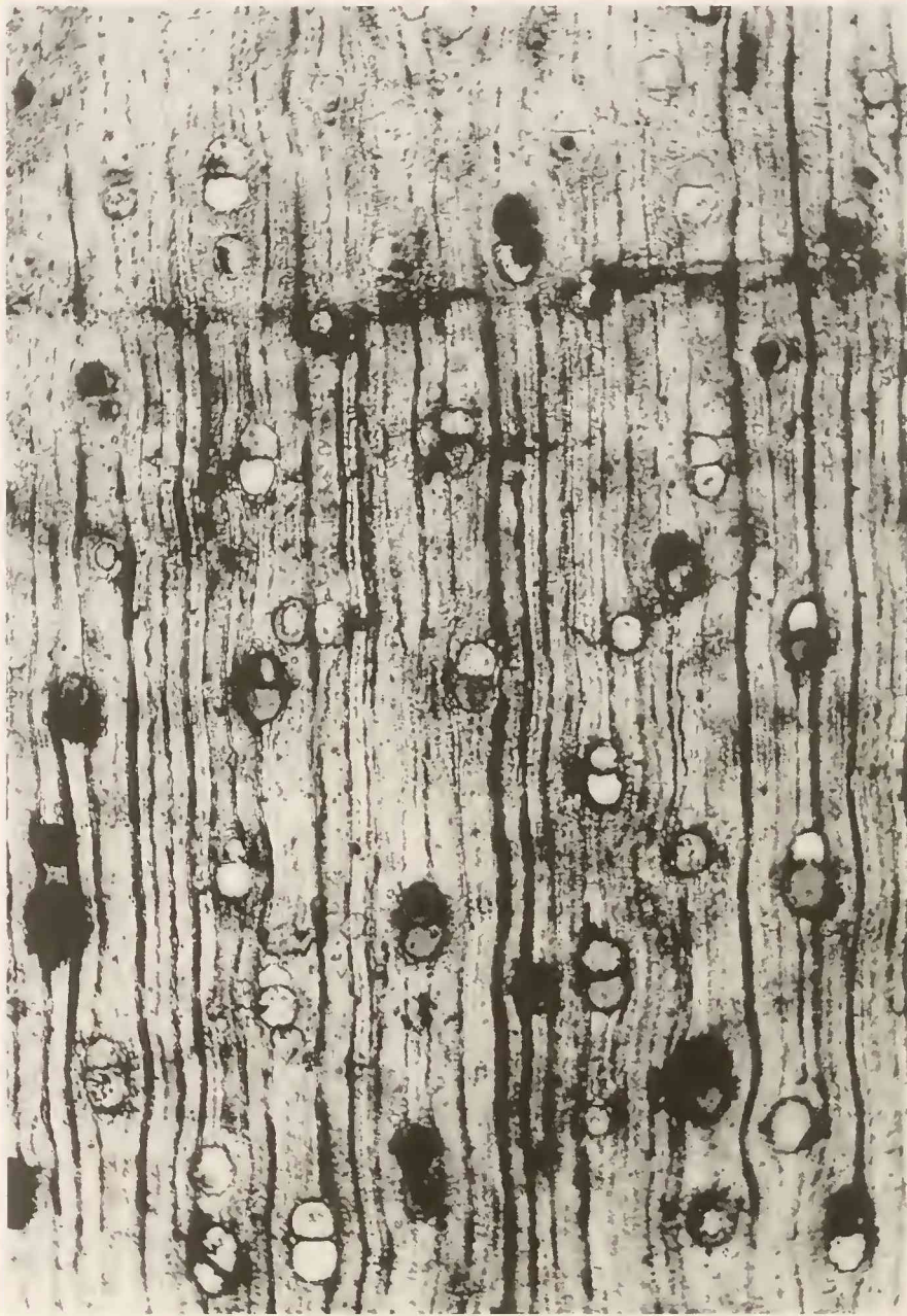
Abb. 6. Carapoxylon cf. xylocarpoides . – Querschliff. Zerstreutporige Gefäße mit dunklen Inhaltsstoffen und marginalem Parenchymband; \times 25 .
