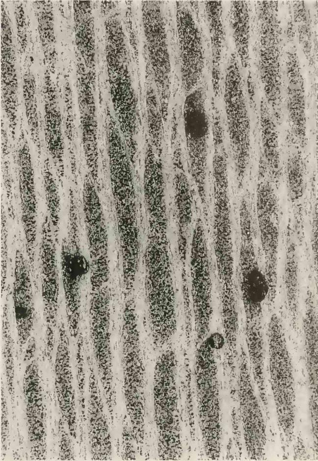
Abb. 19. *Platanoxylon* sp., Platane, Fundort Zahling. – Tangentialschliff; die breiten und plump geformten Holzstrahlen, typisch für die Gattung *Platanus*, sind im abgebauten Holz noch kontrastreich erhalten geblieben. x 60.
