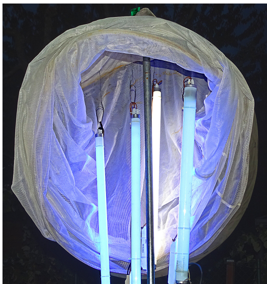
Abb. 1: Digitale Vorschaltgeräte direkt an die Röhren montiert.
