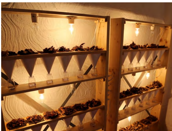
Abb.1: Expeditions-Berlesegestell – die Proben liegen auf Gaze (2 mm Maschenweite), Austreibung der Collembolen durch Licht und Wärme, Fixierung im Törne-Gemisch, das sich in den Plasteboxen befindet.
